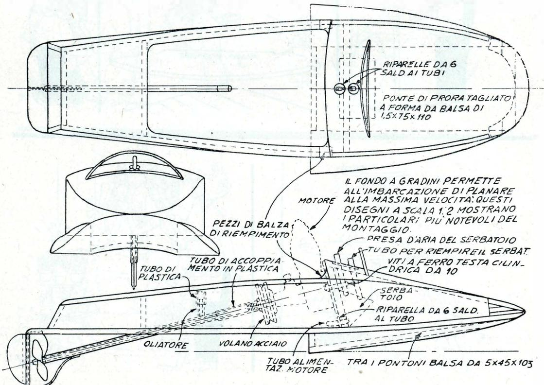
Impastate i disegni eseguiti su carta sul lamierino di ottone dal quale dovrete ricavare le parti metalliche. ritagliate secondo i disegni con forbici da lattoniere e rifinite accuratamente i bordi con una limetta.
