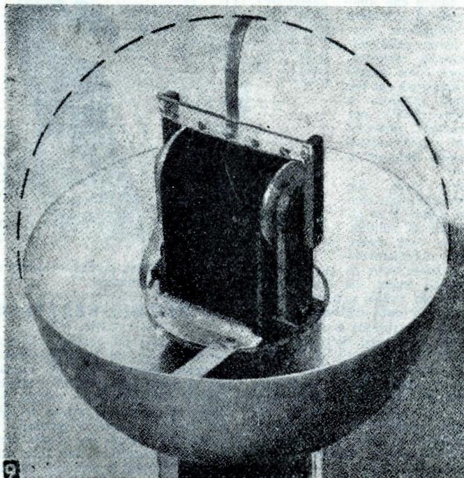
Una volta ultimata la preparazione della scatola che fa da base e montato il complesso della puleggia inferiore, delle spazzole e del motore che assicura il movimento della cintura, siete pronti a completare la vostra macchina elettrostatica con l'aggiunta del complesso costituito dalla spazzola superiore la sfera e la cinghia.
