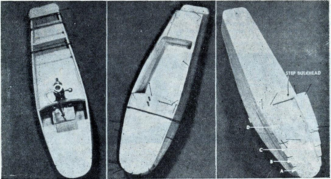
● **SMUSSATE** i bordi della tavoletta di montaggio del motore, del boccaporto e della poppa in modo che si adattino perfettamente. Cementate le fiancate ed assicuratele con spilli e bande di caucciù. Montate il serbatoio del carburante ed assicuratele al rovescio della tavoletta di montaggio del motore. Aggiungete il ponte di poppa, smussate i pezzi della prua con una lama
