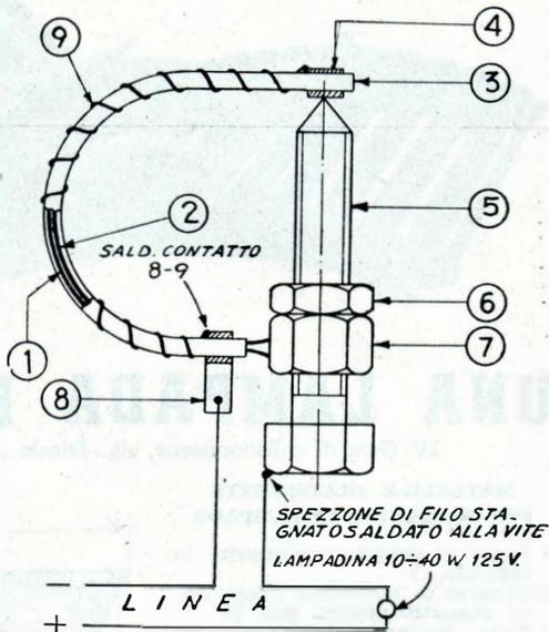
che da inserirlo su di un circuito con una lampada da 10-40 W. e regolare la vite (5) fino al perfetto funzionamento del lampeggiatore.
